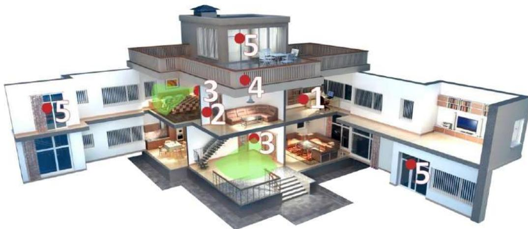
Ubicación de instalación típica de los dispositivos: 1. Panel de control AX PRO
