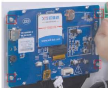
Figura 9-3 Extracción de los tornillos que fijan la pantalla
