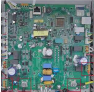
Figura 9-16 Comunicación y cables PE
