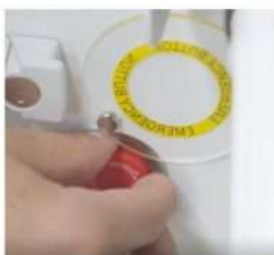
Figura 9-24 Extracción del botón de parada de emergencia
