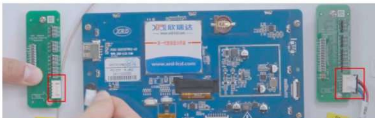
Figura 9-12 Desconexión del bloque de terminales de comunicación
