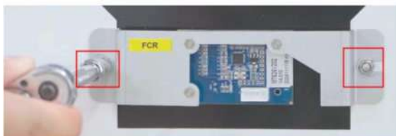
Figura 9-10 Extracción de los tornillos que fijan el soporte RFID
