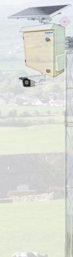
e) Un soporte trasero, para montaje a poste y/o columnas de alumbrado, compuesto por un perfil de acero galvanizado de origen espesor BWG #14. Este soporte admite diversos tipos de fijación (mediante zunchado con fleje de acero inoxidable; fijación mediante tirafondo sobre poste de madera; etc.).
