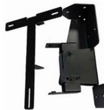
La unidad 6500MMK permite montar detectores óptico lineales y reflectores en una pared vertical o en el techo. El kit permite un rango de alineación adicional para los casos en los que el detector y el reflector no se puedan montar con 10° de separación. Además, el kit incluye el hardware necesario para montar una sola unidad de transmisora/receptor o un solo reflector.
