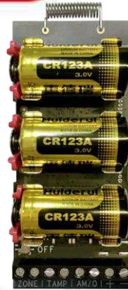
El transmisor inalámbrico de una sola entrada DS-PM1-I1-WB permite conectar detectores cableados de terceros, como PIR exteriores, al sistema de alarma AX PRO.
