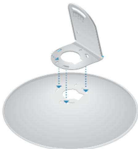
2.Alinee los pasadores de alineación de la carcasa trasera con el orificio de alineación del soporte para platos. Inserte los pasadores y empuje hasta que encajen en su lugar.
