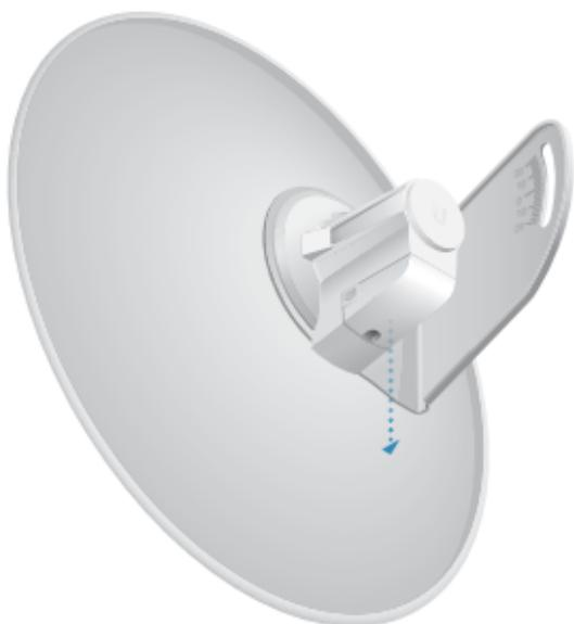
4 Conecte la alimentación de antena: a. Inserte la alimentación de la antena en la carcasa trasera y empujela hasta que encaje en su lugar con un clic. b. Tire ligeramente de la alimentación de la antena para asegurarse de que esté bloqueada en su lugar y el botón de liberación está completamente acoplado.
