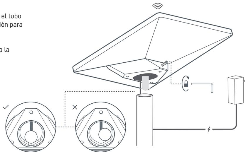
**INSTALACIÓN DEL ADAPTADOR DE TUBO**
