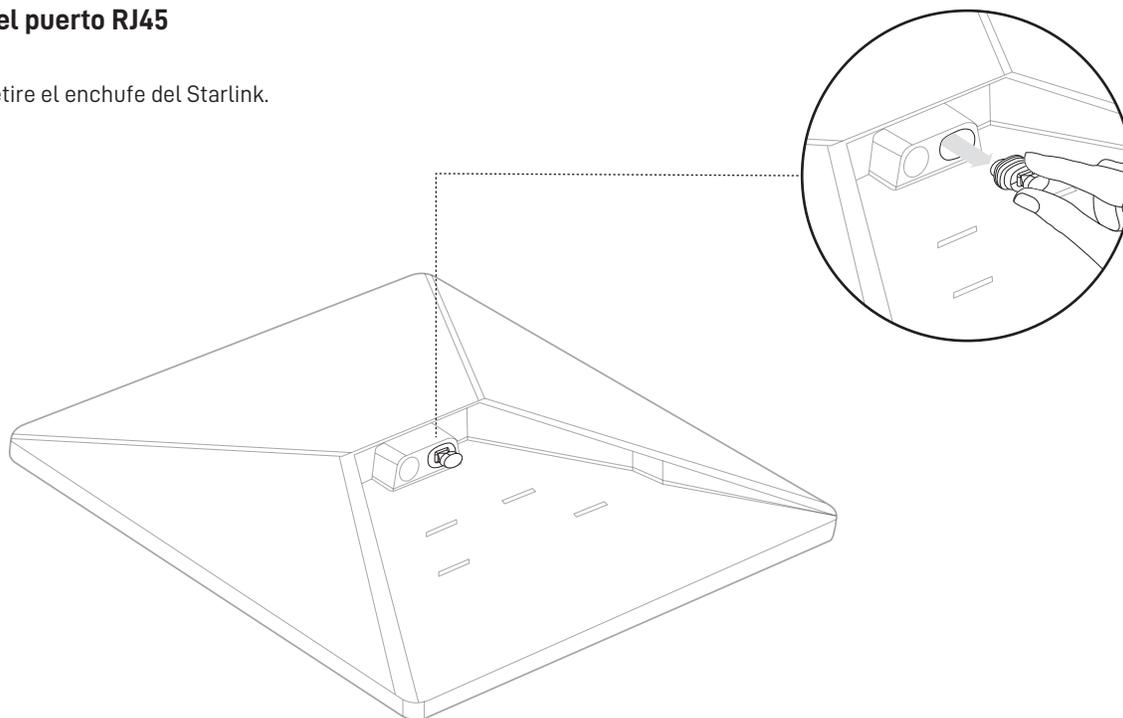
2. Conecte el cable para Starlink Mini que está disponible en [shop.starlink.com](https://shop.starlink.com) o su propio cable Ethernet en el puerto. Conecte el otro extremo del cable a la red en malla cableada o al hardware de terceros.
