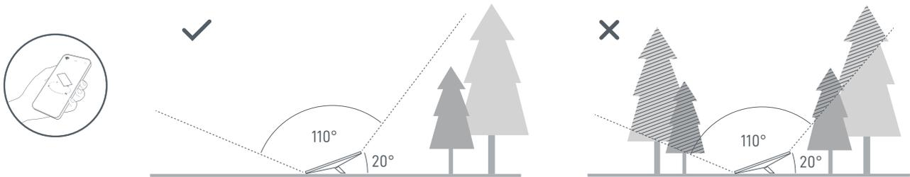
Si no puede encontrar un campo de visión despejado desde el nivel del suelo, considere la posibilidad de instalar la antena en un lugar elevado, como un techo, un poste o una pared. Puede comprar soportes y accesorios adicionales en la tienda de Starlink.
