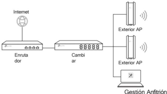
La computadora ejecutará el software de gestión centralizada, el cual puede estar en la misma subred o en una subred diferente a la de los puntos de acceso (APs). Este software se utiliza para administrar los APs de forma centralizada.
