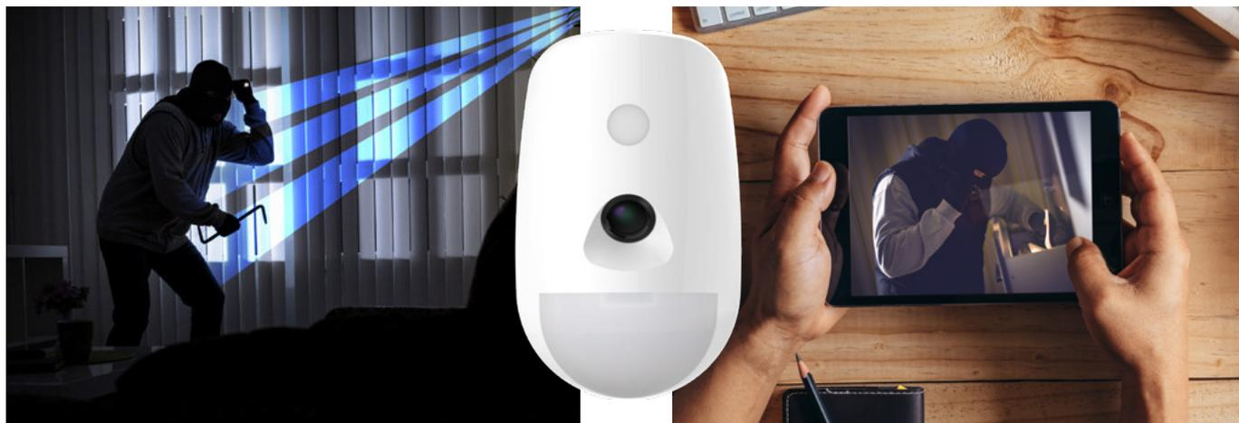
Mediante el PIRCAM podemos verificar inmediatamente una intrusión desde el mismo momento en que se produce. El dispositivo incorpora una cámara con resolución de hasta 640x480 para la captura de instantáneas, así como un led infrarrojo para permitir la visualización en escenas sin iluminación. Asegura su perfecta comunicación con el panel a través de un canal RF exclusivo CAM-X.
