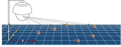
**3D** La función de posicionamiento 3D permite a los usuarios ver la imagen detallada en el canal PTZ con alta eficiencia al marcar el área interesada en el canal Bullet.
