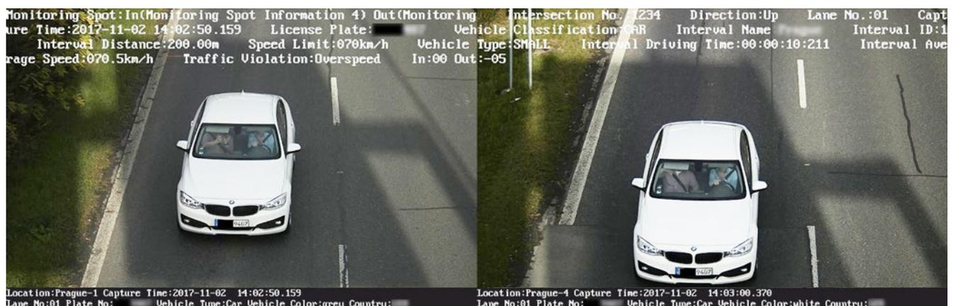
La detección de velocidad en tramo es posible con las cámaras ITS de Hikvision, las cuales cuentan con una analítica vídeo y tecnología deep learning de medición de velocidad embebida. Además, pueden ser interconectadas con sistemas de detección de velocidad (radar) para realizar una doble verificación.
