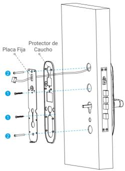
4 Con la perilla de seguridad en posición vertical, fije el panel posterior con tornillos como se muestra a continuación.
