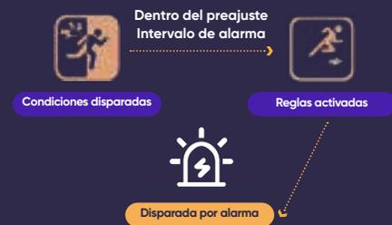
Agilice el sistema de seguridad de los usuarios combinando eventos como la protección perimetral, la detección de movimiento y dos entradas de alarma. Cada regla de eventos combinados permite hasta 3 pre-eventos, satisfaciendo necesidades específicas. (Admite 1 regla para la resolución HeatPro 160, y 2 reglas para la resolución 256)
