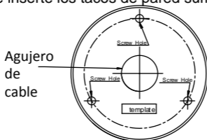
Figura 2-1 Plantilla de perforación
