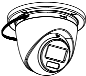
Figura 2-46 Inserte la cámara en la caja soporte
